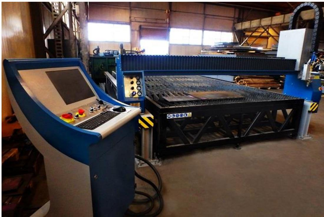
Мы предоставляем услуги в области плазменной и кислородной резки листов углеродистой стали с числовым программным управлением. Мы предлагаем резку ЧПУ по чертежам клиентов в диапазонах:
