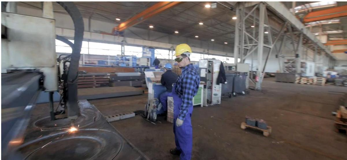
Wir leisten die Dienstleistungen im Bereich numerische Schneiden von Blech aus dem Kohlenstoff. Wir schneiden diesen Bleche mit des Plasma und mit dem Sauerstoff.
